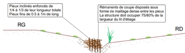
Figure 16 : Profil en travers n°5 avec implantation d'un épis végétal
